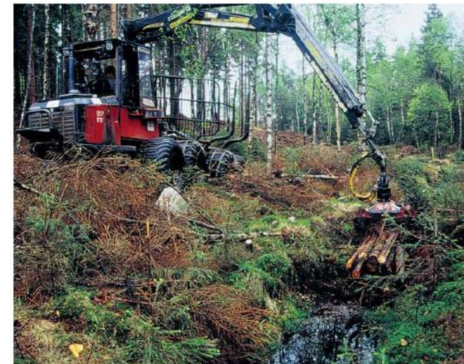
Igenläggning med skotare. Planterad gran närmast diket har avverkat för att skapa en mer öppen miljö och möjlighet för löv att självföryngra sig. En intresserad skogsägare kan också snabba på lövföryngringen genom att plantera till exempel alplantor utmed nya kantzonen. Gallåsen, Västergötland. Foto: Per Pettersson
